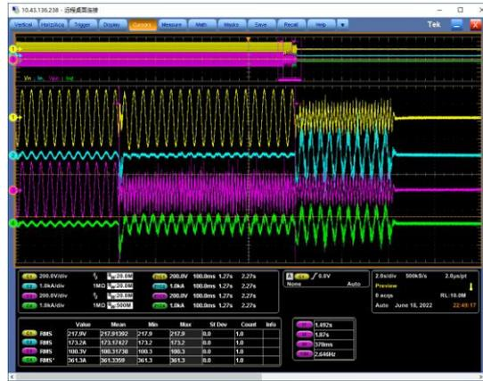
图57 输出短路
