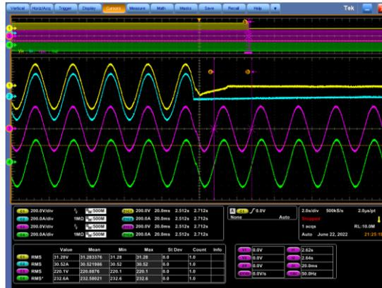
图35 黄色:旁路输入电压, 蓝色:旁路输入电流, 紫色:系统输出电压, 绿色:系统输出电流
