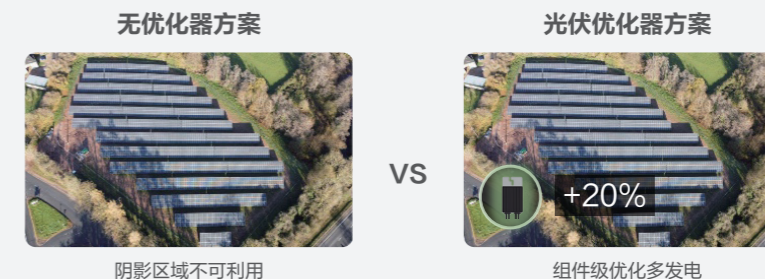
图：无优化器光伏方案与有优化器方案对比
