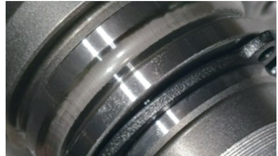
图 1 因轴承电腐蚀产生的“搓板纹”
