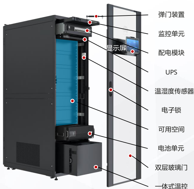
FusionModule500 分解图
