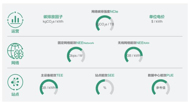
图3-5: 不同层级的的网络能效衡量
